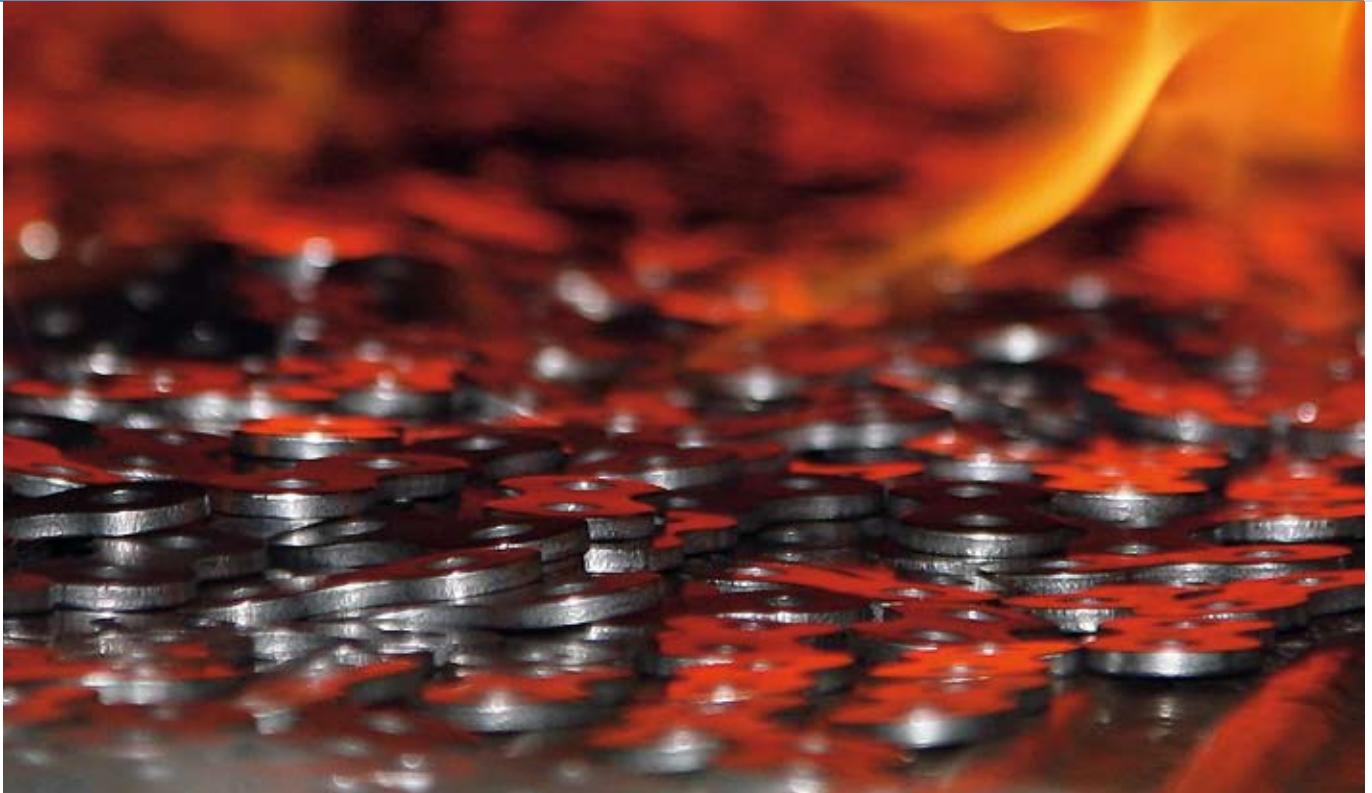
Kettenlaschen im Durchlaufofen
