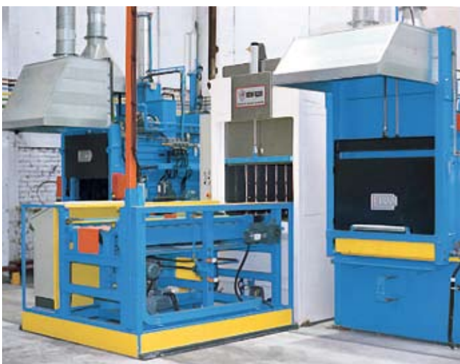
Moderne Anlagen für die Wärmebehandlung: Kammerofenanlage
